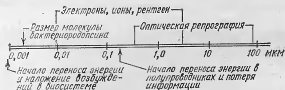
Рис. 3. Разрешающая способность излучений, применяемых для получения микрофин, микросхем и т. д. Расстояния между микроэлементами, при которых начинается перенос энергии
