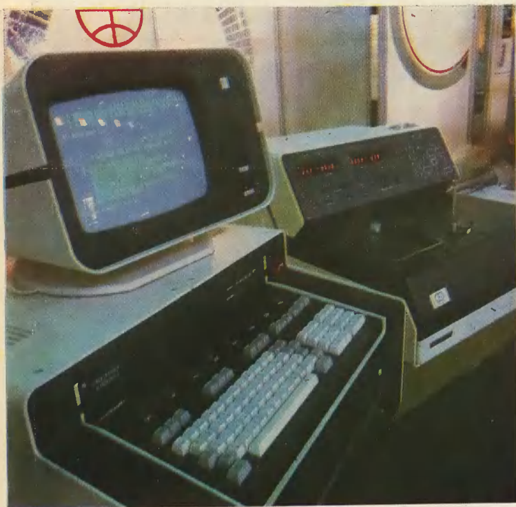
Микропроцессорный экспресс-анализатор кормов Infrapid (ВНР) — фото сверху, справа
