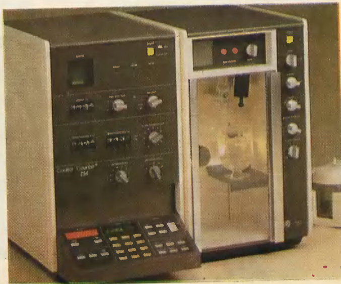
Микропроцессорный анализатор количества и размера частиц Coulter ZM (Англия) — фото внизу, справа
