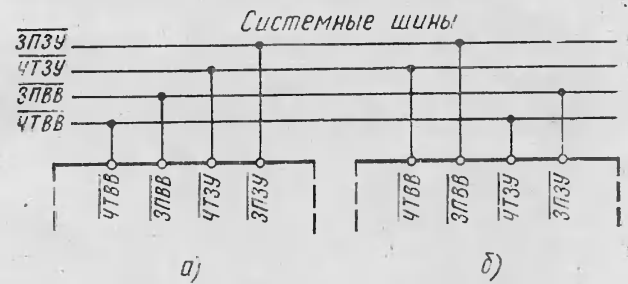
Рис. 4 Способы подключения контроллера КР580БТ57 к системным шинам
