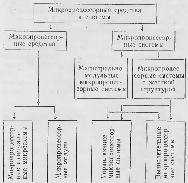
Рис. 1. Терминологическое дерево: «Микропроцессорные средства и системы»
