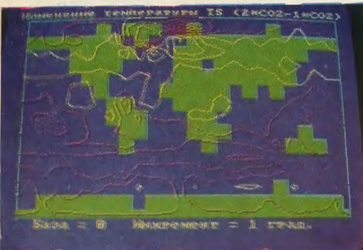
Рис. 3. Система «Климат». Изменение среднегодовой температуры Земли при удвоении содержания углекислого газа в атмосфере
